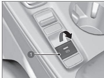
① Spínač elektrickej parkovacej brzdy
