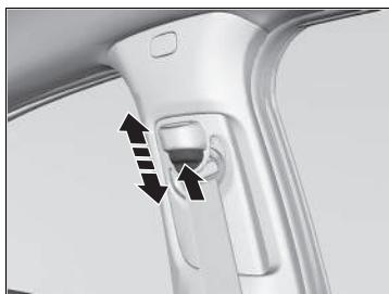
1. Držte tlačidlo uvoľnenia a pohybujte ukotvením nahor a nadol.
