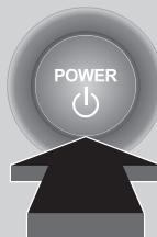
Ak máte pri sebe diaľkový ovládač bezklúčového otvárania a stlačíte tlačidlo **POWER** bez stlačeného brzdrového pedála, režim napájania sa zmení v nasledujúcim poradí: VOZIDLO VYPNUTÉ → PRÍSLUŠENSTVO → ZAPNUTÉ → VOZIDLO VYPNUTÉ.
